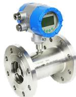
Medidor de flujo tipo Turbina
